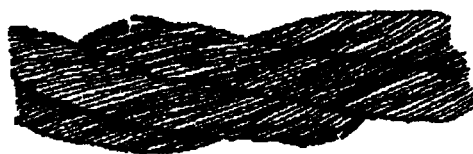
Рисунок 1. Обрывы и смещения проволок каната крестовой свивки.
