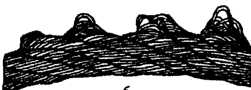
Рисунок 12. Выдавливание проволок прядей: а - в одной пряди; б - в нескольких прядях.
